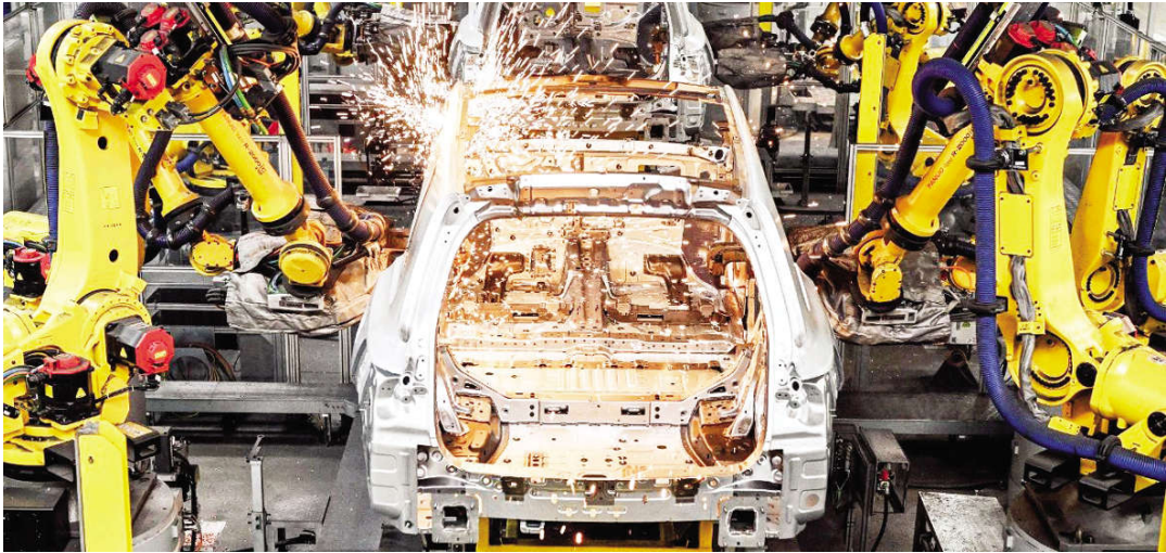
理想汽车江苏常州基地车间,机械手臂进行焊接作业。新华社/图
